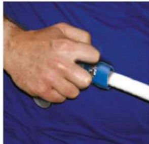
Calibre e chanfre o tubo com as ferramentas adequadas.
